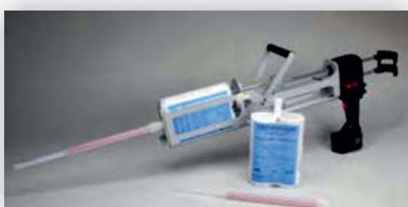
Baterijski pištolj Millennium One Step Battery Powered Applicator je posebno projektiran za nanošenje ljepila i brtvila iz serije Millennium One Step. Jedinstveni oblik omogućuje uporabu u okomitom položaju bez nepotrebnih opterećenja leđa. Uređaj se napaja akumulatorom na punjenje napona 14,4 V. Motor radi s manjoj strujom za dulje vrijeme uporabe i kraće vrijeme punjenja.
