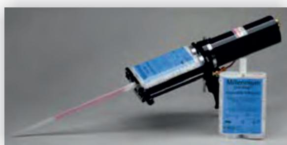
Pneumatski pištolj Millennium One Step Pneumatic Single Bead Applicator namijenjen je nanošenju ljepila Millennium One Step. Pištolj za pogon klipova upotrebljava komprimirani zrak i ima najveću silu potiska oko 800 kg. Za rad uređaja One Step Pneumatic Single Bead Applicator je potreban kompresor (nije u kompletu).
